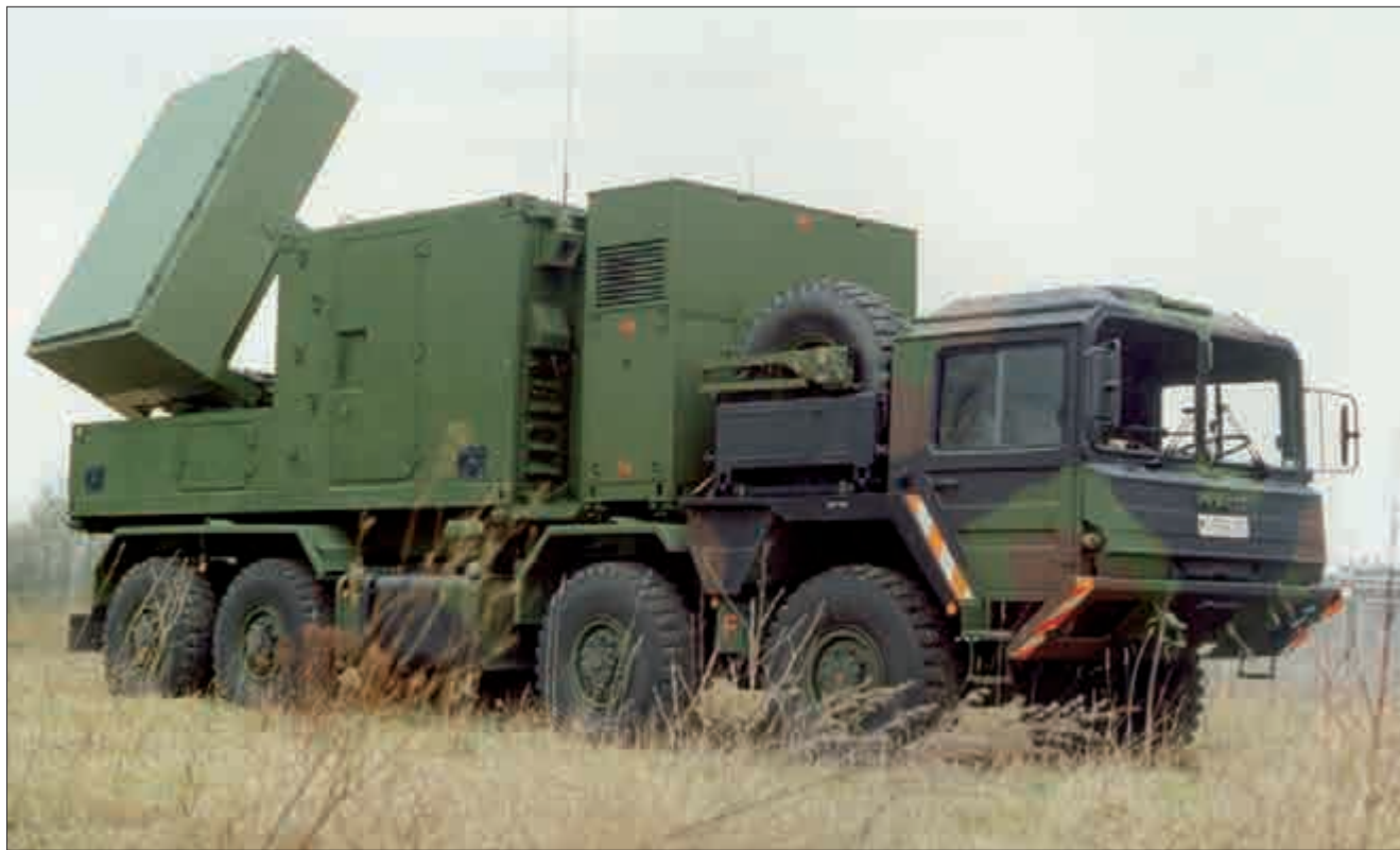
VERBUND AUFKLÄRUNG-FÜHRUNG-WIRKUNG-UNTERSTÜTZUNG: DAS ARTILLERIERADAR COBRA ORTET FEINDLICHE FEUERSTELLUNGEN UND WIRKMITTEL
